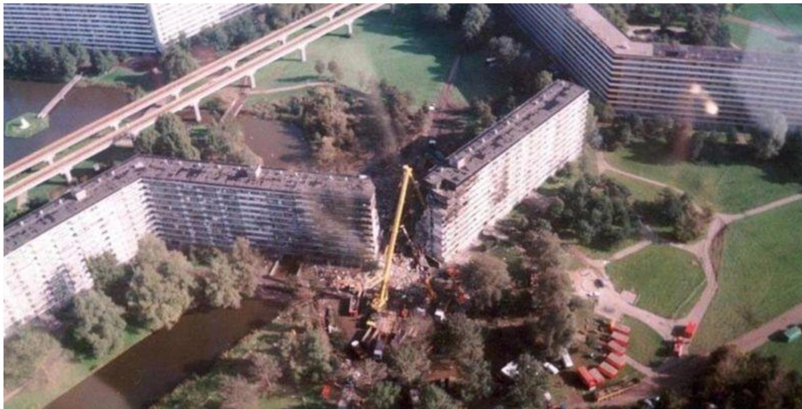
1992年オランダのアムステルダムスキポール空港を離陸したジャンボジェット機が、11階建て高層アパートに墜落。離陸上昇中に、疲労によるエンジン脱落で制御不能に。
