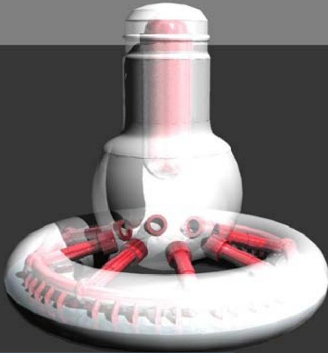
ダウンコマ先端が水中に入っているから水蒸気が水中に入って凝縮できる。
